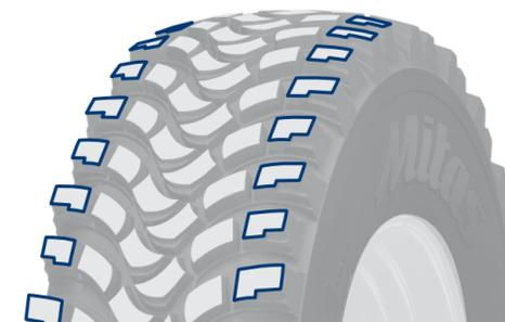
Les différentes longueurs des pavés et leur alignement donnent un spectre sonore avec une faible amplitude – le bruit est divisé en plusieurs plages de fréquences – réduction du bruit au roulement.
