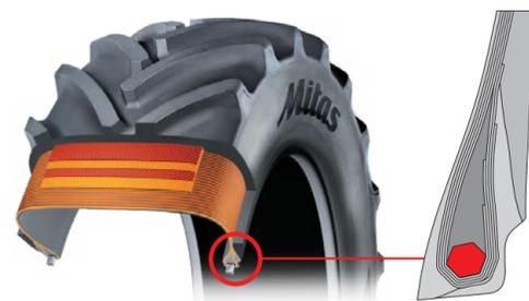
Ajustement parfait de la jante grâce à la technologie Hexacore : la forme hexagonale de la tringle permet de renforcer le talon et de garantir un couple élevé.
